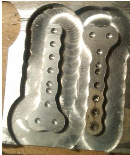
Figura 3: Detalle del prototipo de prótesis para fractura en aluminio.
