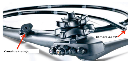
Figura 1: Endoscopio con sus principales componentes. Fuente: American Society for Gastrointestinal Endoscopy
