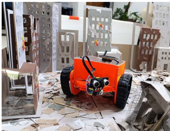
Figura 5: Microrobot para la búsqueda de personas en escombros y accidentes tras un desastre natural. Fuente: https://www.cenditel.gob.ve/portal/2024/09/11/np-11092024-1/
