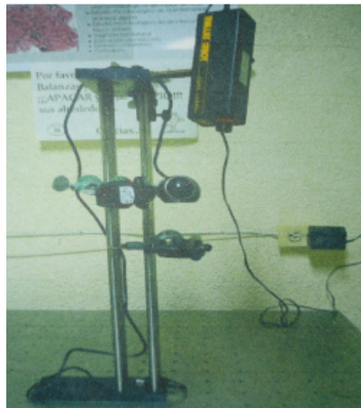
Figura 2: Equipo óptico “speckle” y mesa antivibratoria. Fuente: Belandria (2011).
