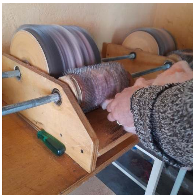
Figura 7. Proceso de peinado de lana en una cardadora eléctrica. Foto: Roselys Barrios Fuente: Shantiluz Sánchez (2023)
