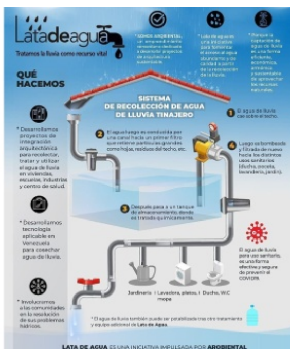
Figura 1. Infografía del Sistema de Recolección de Agua de Lluvia del Modelo "Lata de Agua" Fuente: @latadeagua_ (2020)
