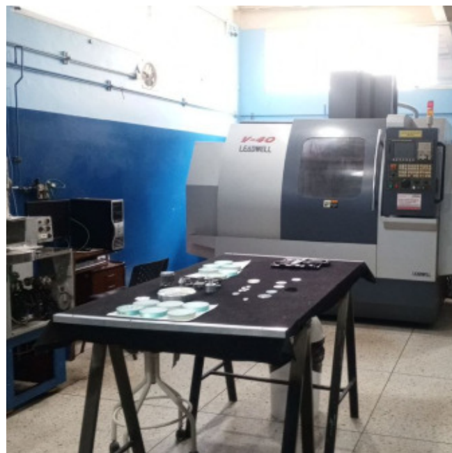
Figura 5: Mecanizado CNC. La máquina Leadwell V-40, permite realizar cortes y desbastes con la precisión de 3 mm.
