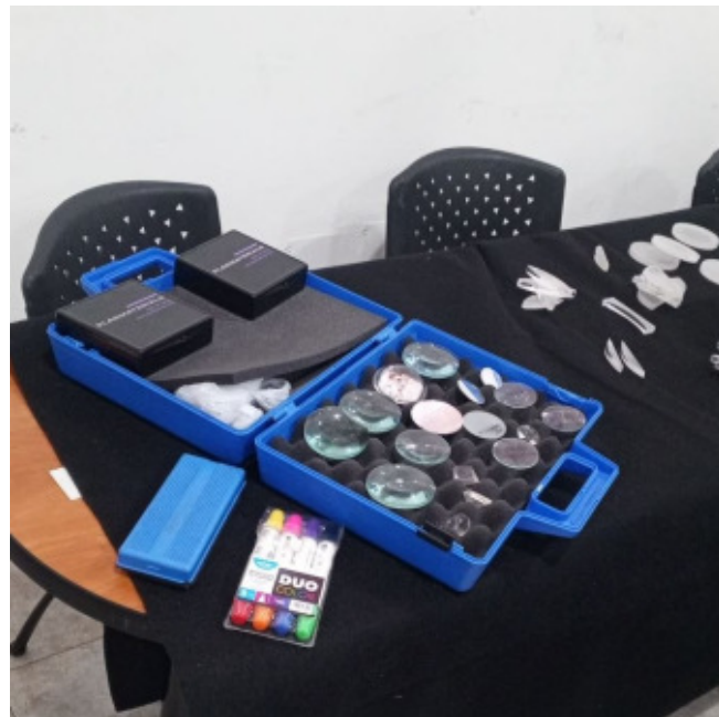
Figura 4: Kit del sistema modular de enseñanza óptica desarrollado por CIDATA.
