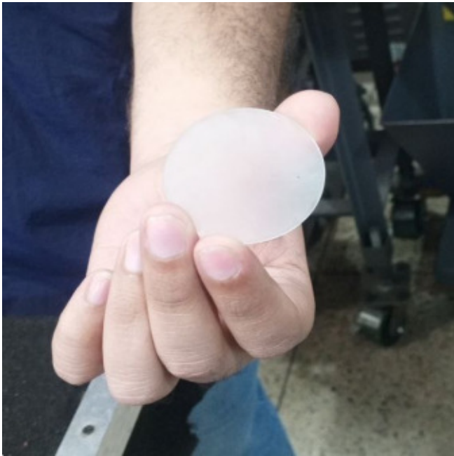
Figura 11: Lente esmerilada y lista para el pulido. Fuente: Jesús Erazo (2026).
