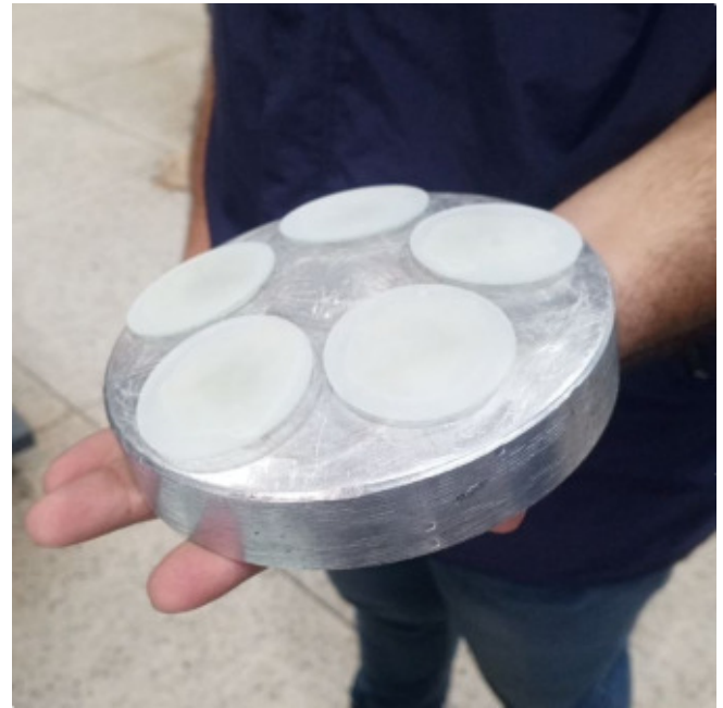
Figura 13: Molde de pulido múltiple. Bloque utilizado para el pulido simultáneo de varias piezas.
