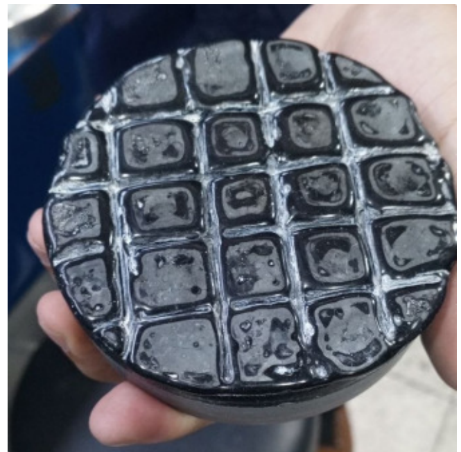
Figura 14: Herramienta de pulido fabricada con brea óptica, un material viscoelástico esencial para el acabado final de lentes y espejos.
