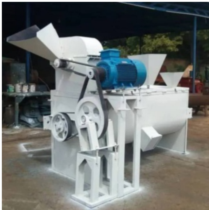
Figura 1. Planta procesadora de alimento animal ubicada en Valle de la Pascua, con capacidad de producción de 40 Tn/día Fuente: Héctor Landaeta (2012)
