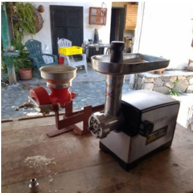
Figura 4. Molino de disco para granos secos con adaptación y adecuación de tecnologías existentes Fuente: Héctor Landaeta (2025)
