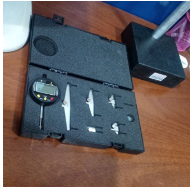
Figura 17: Esferómetro digital de alta precisión para la validación geométrica de las piezas. Fuente: Jesús Erazo (2026).
