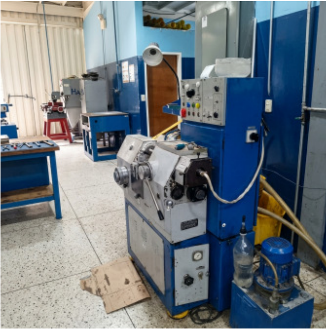
Figura 7: Máquina de redondeo y centrado. Eliminación de las irregularidades del lente, para que el centro geométrico coincida con su centro óptico.
