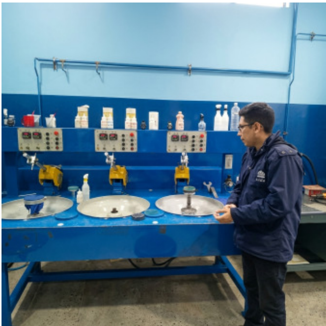
Figura 12: Estación de pulido automatizada. Se utilizan agentes abrasivos de granulometría decreciente (óxido de zirconia) para eliminar la rugosidad y lograr una superficie perfectamente lisa y transparente. Fuente: Jesús Erazo (2026).
