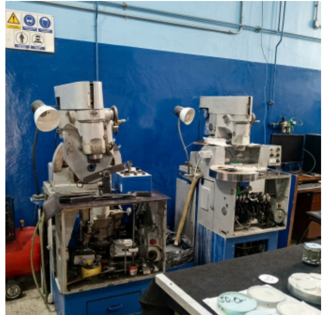
Figura 9: Máquinas generadoras de curvatura. Realizan el desbaste abrasivo del vidrio para transformar los discos planos en superficies cóncavas o convexas.
