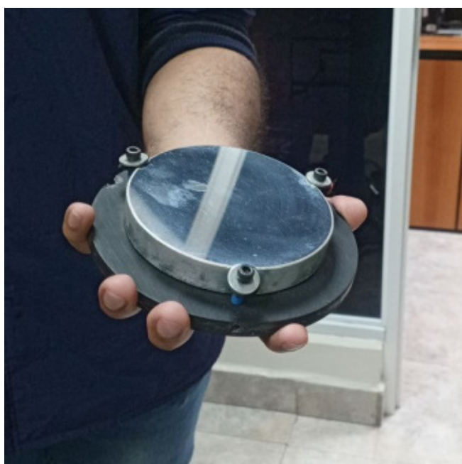
Figura 19: Espejo astronómico obtenido por aluminizado al vacío. Capa de aluminio de apenas 100 nanómetros de espesor.
