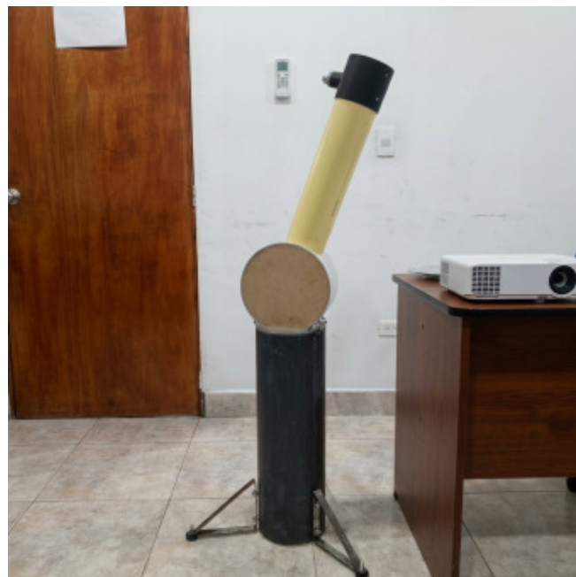
Figura 2: Telescopio reflector newtoniano artesanal Sué desarrollado por CIDATA. Fuente: Jesús Erazo (2026).
